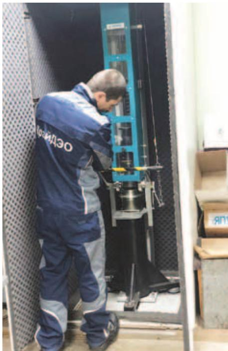
Уплотнитель Маршалла. Предназначен для изготовления образцов из асфальтобетонных смесей.
