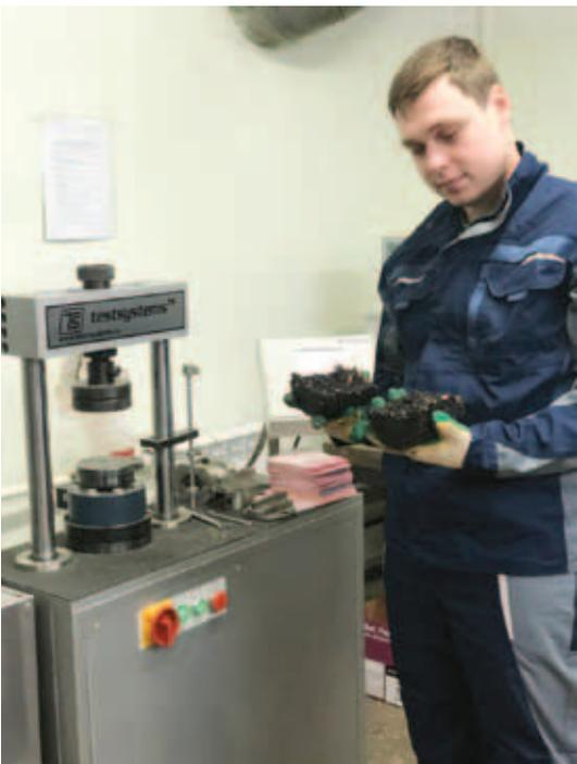
Универсальная испытательная машина. Определение прочностных характеристик асфальтобетона
