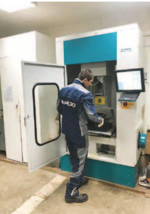
Секторный уплотнитель. Изготовление образцов-плит для определения глубины колес
