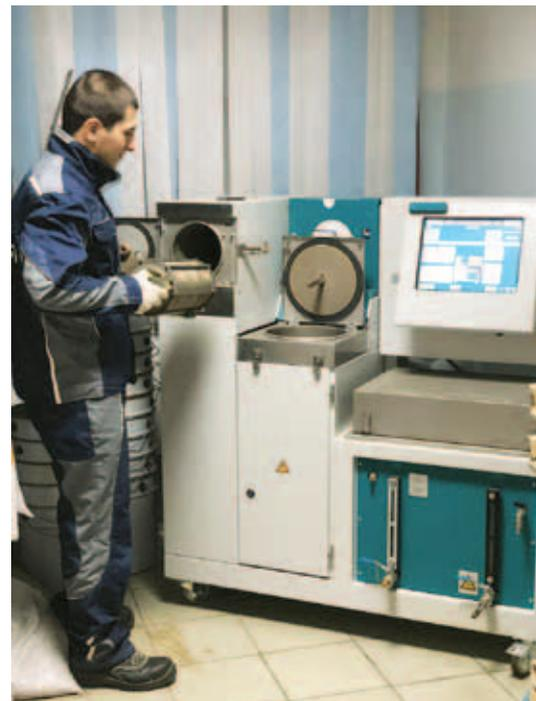
Асфальтоанализатор. Определение состава асфальтобетонных и щебеночно-мастичных смесей
